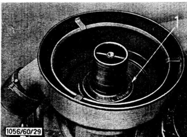
1 Filtergehäuse mit Marke „Normalstand“ und „Ölhöchststand“
