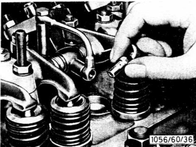
Öldüsenschraube für Ölleitung der Kipphebel
