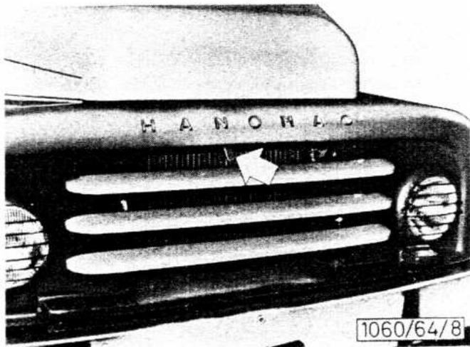
Sicherungsriegel für Motorhaube
